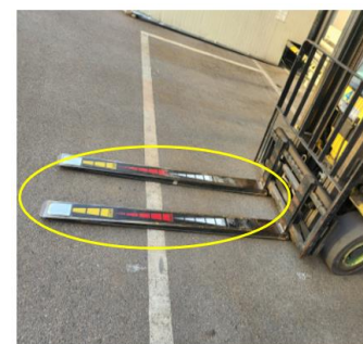
▶ 포크 마커 설치
