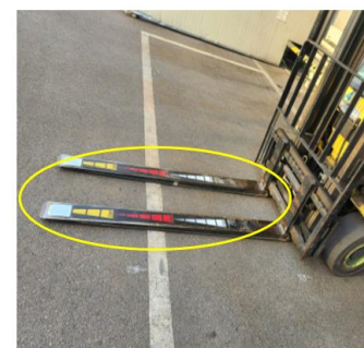
▶ 포크 마커 설치
